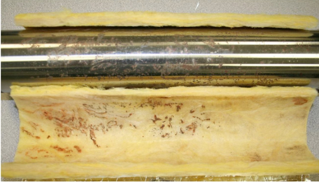
처리안 된 파이프 : 정기적인 염화물 주입으로 고온 조건에서 240 시간 동안 테스트 진행
